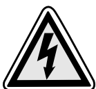
Tensão elétrica perigosa
