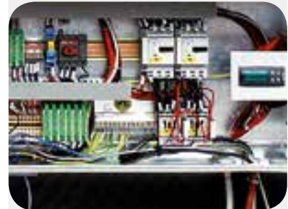
Controllore elettronico (HP2). Electronic controller (HP2). Contrôleur électronique (HP2). Elektronisches Steuergerät (HP2). Controlador electrónico (HP2). Звукоизоляция компрессорного отсека.
